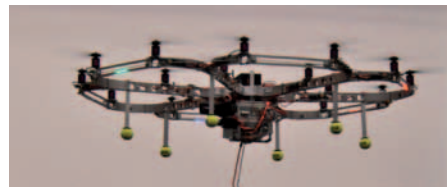
Abbildung 3: Flug von 25 kg 1:4 Modell Testträger an der Hochschule Karlsruhe
