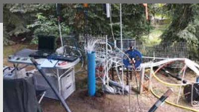
Abb. 4: Versuchsaufbau für einen Tracerversuch an einem zweifach verfilterten Versuchsbrunnen
