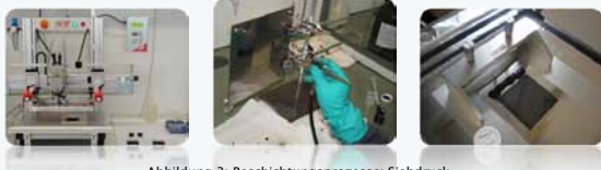
Abbildung 3: Beschichtungsprozesse: Siebdruck, Nass-Sprühverfahren und Filmziehverfahren.
