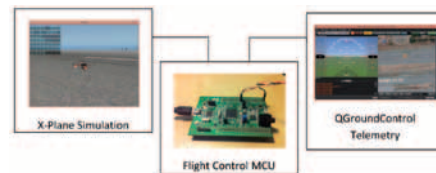
Abbildung 4: Blockschaltbild der Hardware-In-The-Loop (HIL) Simulationsumgebung
