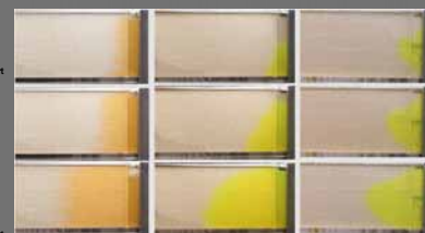
Abb. 5: Visualisierung technisch erzeugbarer vertikaler Infiltrationsverteilungen mit Hilfe eines glaskugelgefüllten Spaltmodells
